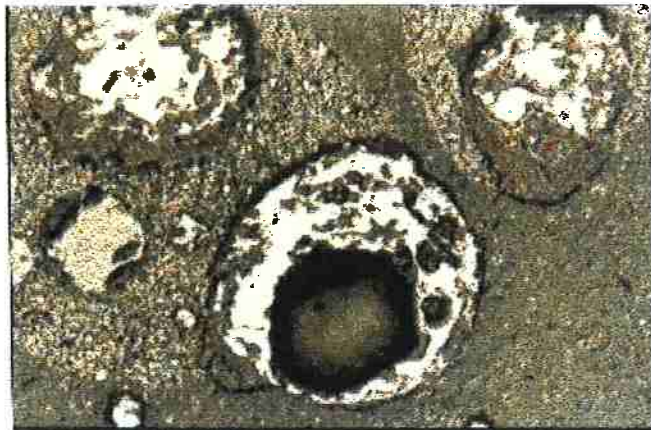
Fig. 8: PAE-R2, nota-se o vazio no interior da partícula (aum. 160x) (27)
