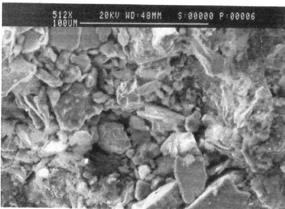
Fig. 61: Micrografia de PAR-I (aum. 512 x), região pobre em aglomerantes, ocorrendo reação de aglomeração à direita. Notam-se partículas de minério de Ferro na parte inferior, onde não houve preenchimento por partículas menores.
