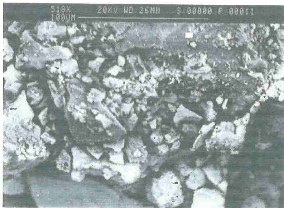
Fig. 65: Micrografia de PAR-XXIV (aum. 518 x), região pobre em ligantes, bem heterogênea, com grande variação na granulometria das partículas. O retângulo na parte superior indica a área de análise do EDS.
