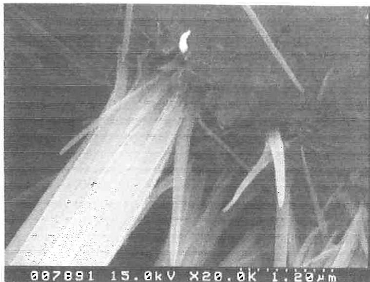
Fig. 21: Micrografia de PAR-microestrutura prismática, provável etringita (aum. 20000 x) (32)
