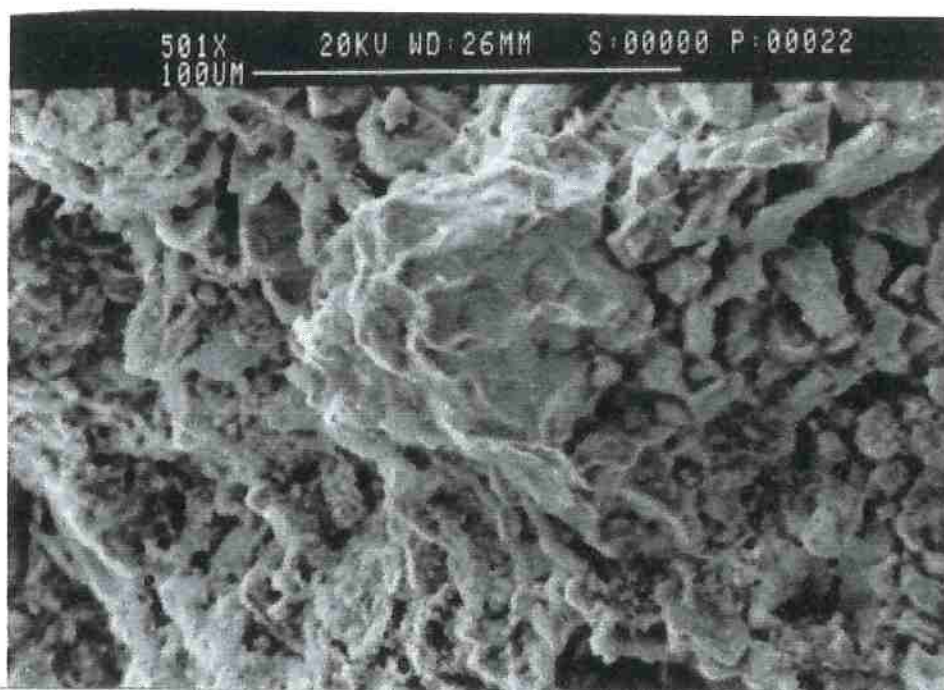
Fig. 64: Micrografia de PAR-VI (aum. 501 x), região com predomínio de (provável) estrutura em gel, porém ainda heterogênea.
